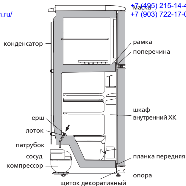
Рисунок 4 — Схема слива талой воды из ХК
